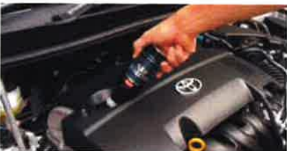
オイル添加剤は、ボンネットを開けて、エンジンのオイルキープを外して、指定された量を注入するだけです。
